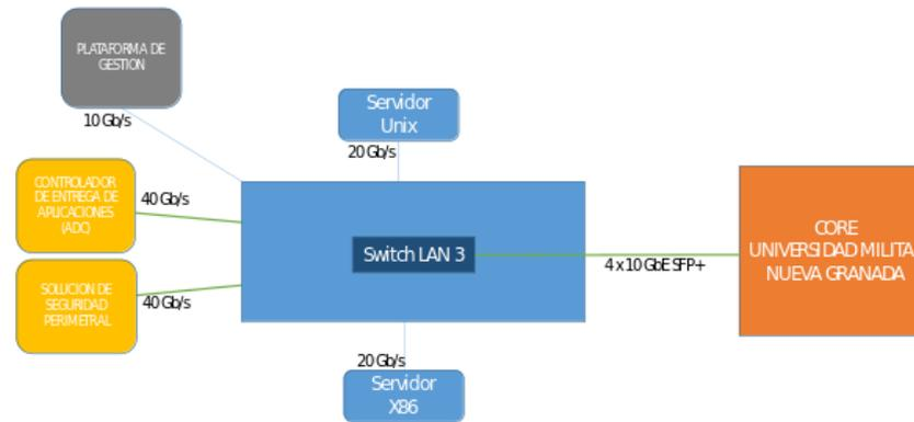
La solución debe ofertar los módulos 10G necesarios para conectarse en la modalidad de enlaces agregados con los Switch Core ubicados en cada sede, que corresponde a un Switch Juniper EX8208 con tarjeta de 40 puertos SFP+. Deben proveerse al menos 6 puertos de Fibra óptica a 10 Gbps por cada enlace y los servicios especializados de instalación y configuración necesarios. La solución debe soportar calidad de servicio y/o clases de servicio para poder transportar el tráfico de la red de datos.
