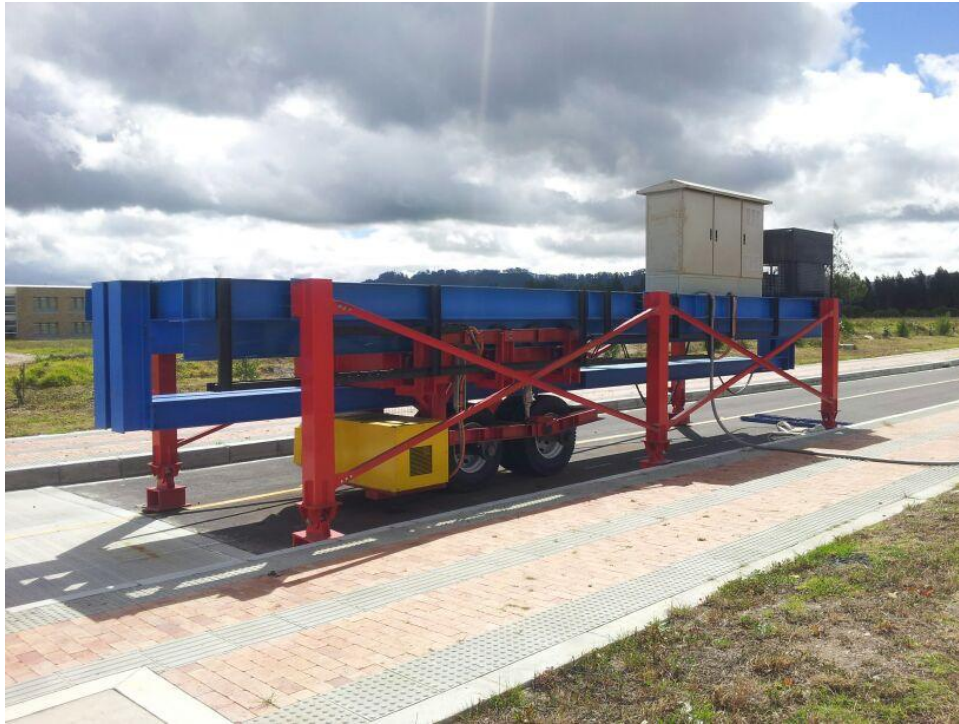
Figura 20. Equipo Pista de Prueba de Pavimentos de la UMNG
