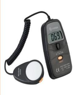
A handheld digital luxometer with a black body and a white sensor head, displaying "0097" on its screen.                                        | <p>Es un instrumento de medición que permite medir simple y rápidamente la iluminación real y no subjetiva de un ambiente.</p>                                                              |
