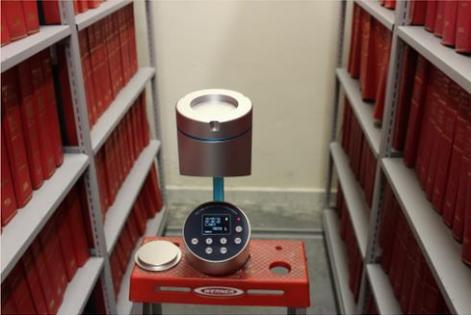
A particle counter device with a digital display and a sensor, placed on a red stand in a room with red shelving units. | <p>Éste equipo de monitoreo realiza mediciones continuas de partículas de manera simultánea en tiempo real, utilizando tecnología innovadora de espectroscopia de banda ancha.</p>          |
