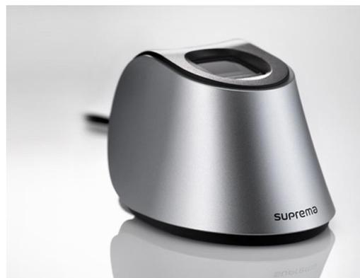
**Figura 26 Enrolador Biométrico**
